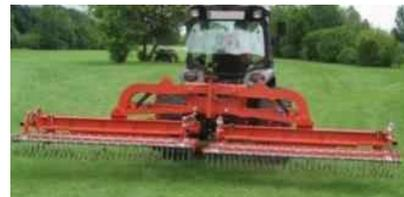
Et puis lorsque le gazon devient trop compact sous l'effet des crampons des joueurs, alors il faut passer à une aération en profondeur, c'est le **décompactage**. L'outil muni de griffes de 20 à 28 cm de long et de 28mm de diamètre défragmente carrément le sol. Un décompactage est nécessairement suivi d'un **sablage** puis d'un balayage. Ces derniers favoriseront la pénétration des nutriments vers les racines.
